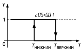
Рис. 3.15. Компаратор срабатывает по нижней уставке:
