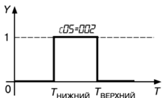
Рис. 3.16. Компаратор срабатывает внутри установленных пределов
