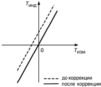
Рис. 3.5. Коррекция "сдвиг характеристики"
