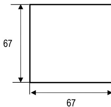
Рисунок Б.2 – Разметка щита для крепления измерителя
