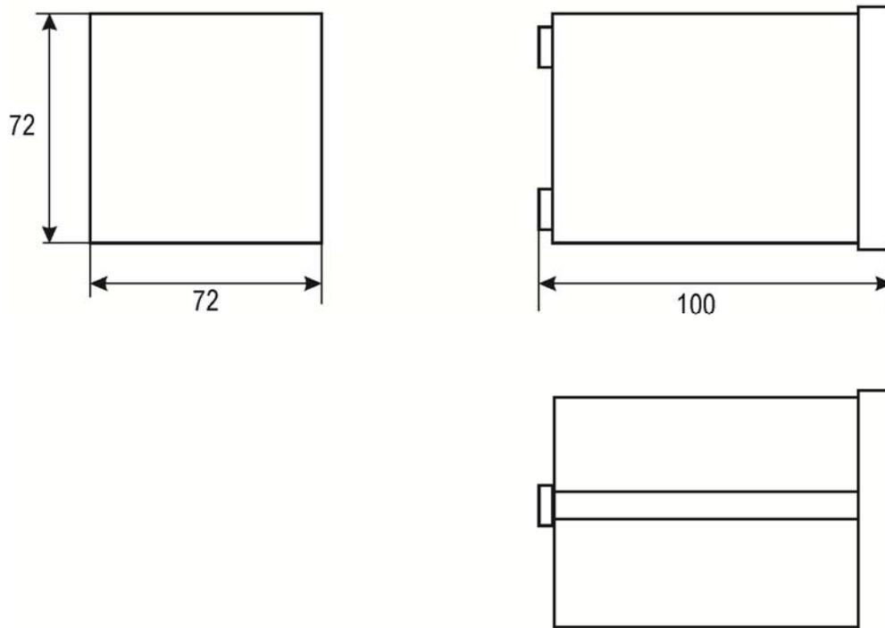
Рисунок Б.1 - Габаритные размеры измерителя
