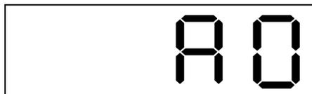
Подать на вход **0 мВ**. В этом режиме при нажатии на кнопку ◁ или ▷ произойдёт фиксация значения входного сигнала, соответствующего нулевому значению термо-ЭДС.
