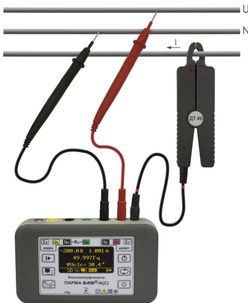
Рисунок 14 Схема подключения для измерения мощности
