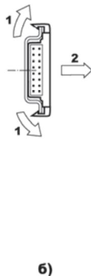
**Рисунок 6.3 – Демонтаж контроллера с DIN-рейки**
